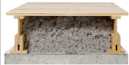
Abb. 4: Begehbare Ständerkonstruktion auf massiver Dachdecke mit Zelluloseflocken gedämmt.
